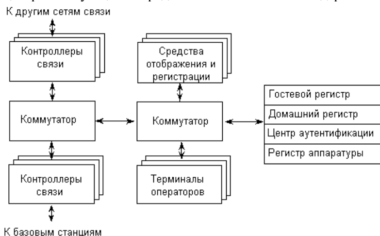
Рисунок 1. Блок-схема центра коммутации СМС.
