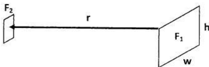
Рисунок А.3.1. Расположение излучающей поверхности пламени и облучаемой поверхности материала соседнего объекта , где w и h - соответственно длина и ширина поверхности пламени.
