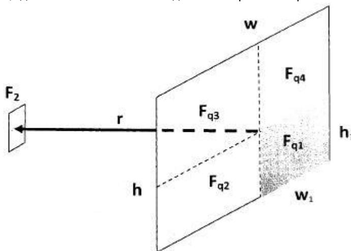
Рисунок А.3.2. Расположение излучающих поверхностей пламени  $F_{q1-q4}$  и облучаемой поверхности материала соседнего объекта , где  $w_1$  и  $h_1$  - длина и ширина соответствующей части поверхности пламени.
