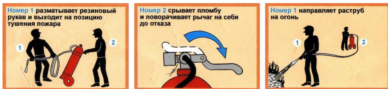
Рис. 7.5. Приведение в действие передвижного углекислотного огнетушителя
