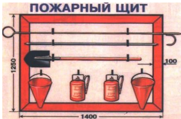
Рис. 7.21. Внешний вид пожарного щита
