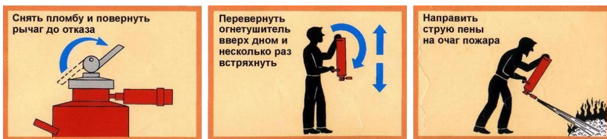
Рис. 7.9. Приведение в действие химического пенного огнетушителя
