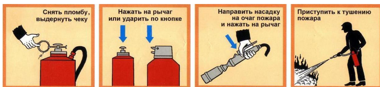
Рис.7.11. Приведение в действие воздушно-пенного огнетушителя
