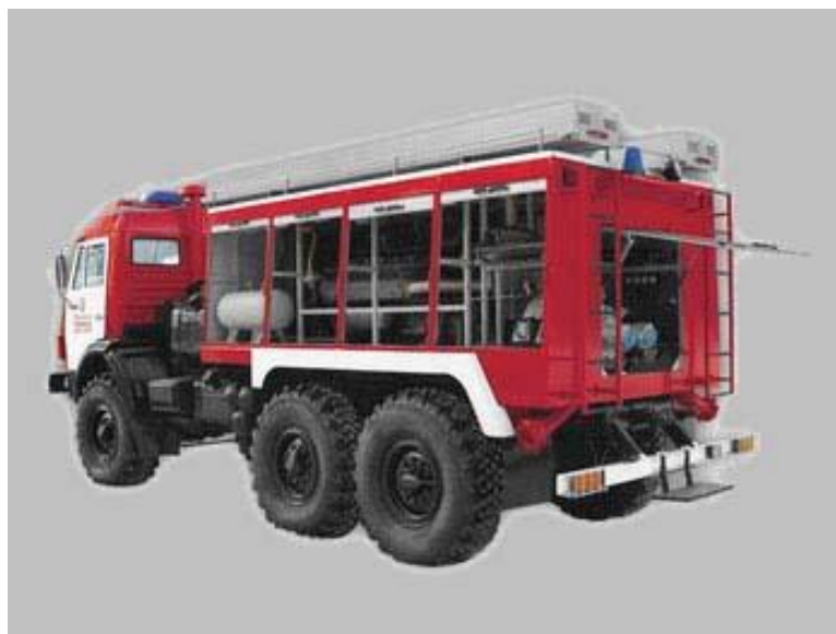
Рис. 6.6. Внешний вид пожарной насосной станции ПНС-110
