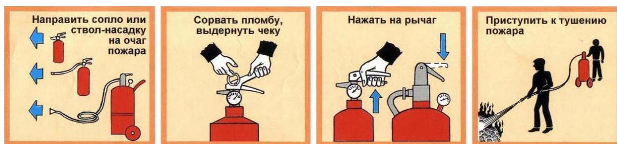
Рис. 7.17. Приведение в действие закачного огнетушителя
