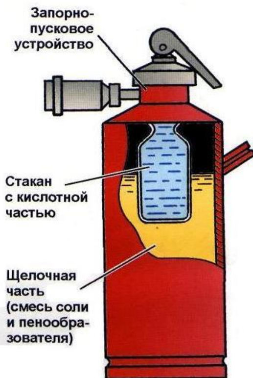
Рис. 7.8. Внутреннее строение химических пенных огнетушителей
