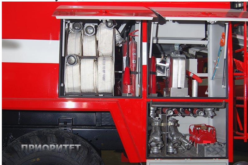
Рис. 6.18. Пожарно-техническое вооружение, размещенное в пожарном автомобиле
