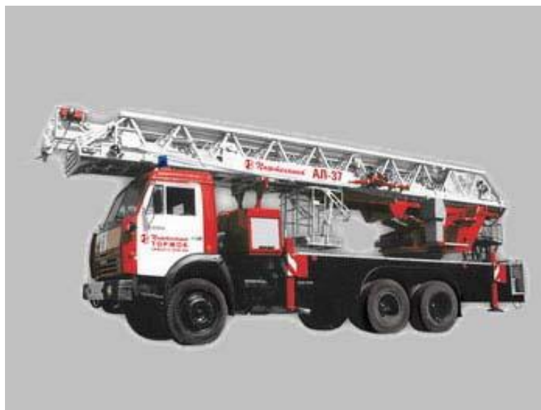
Рис. 6.8. Внешний вид пожарной автолестницы АЦ-37 (подъем люльки на 37 м)
